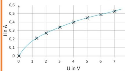
03 Die  $I(U)$ -Kennlinie zeigt, wie die Stromstärke von der Spannung abhängt.
