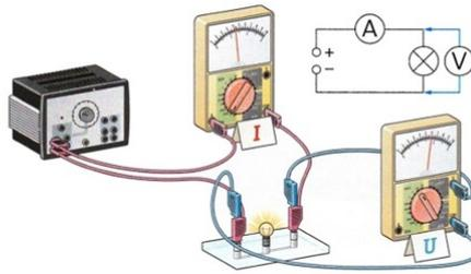
Messung der  $I(U)$ -Kennlinie einer Glühlampe:
